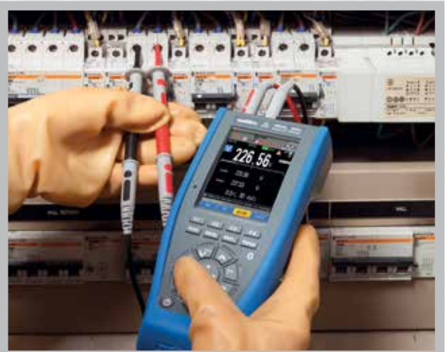
Messungen an elektrischen Schaltschränken
