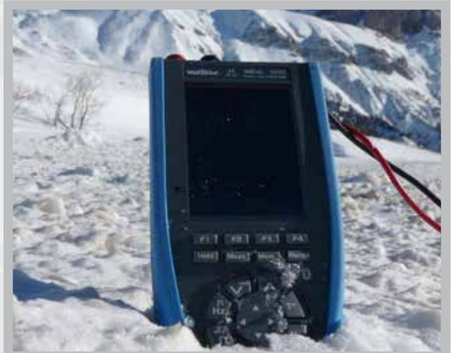
Durch die Schutzart IP67 sind die ASYC IV für schwierige Umgebungen geeignet.
