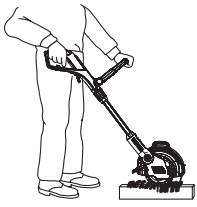
Arbeitsposition 3: Senkrecht Trimmen überhängender Rasenkanten
