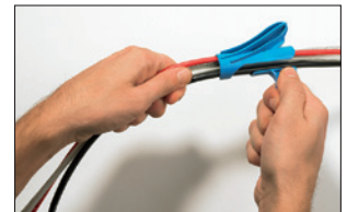
Kabelbündel seitlich in das Aufziehwerkzeug legen.
