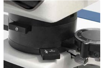
Bertrand-Linse, \lambda Slip, 360° rotierbarer Analysator (herausnehmbar)
