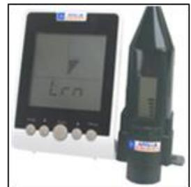
Während dem automatischen Abstimmen blinken beide Displays und die beiden Balkendiagramme werden von unten nach oben gefüllt. Nachdem alle 10 Balken ausgefüllt sind ertönt ein Beep- Ton und zugleich leuchtet das rote LED am Sender. Die Geräte sind aufeinander abgestimmt.
