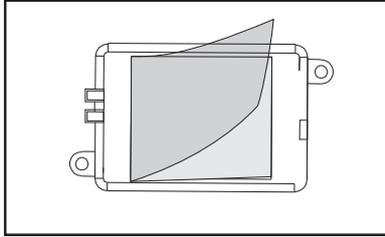
2, Ziehen Sie die Folie vom Klebeband auf der Rückseite vom Regler ab und kleben Sie den Regler auf die gewünschte Stelle.
