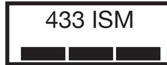
Dieses Etikett weist darauf hin, dass dieses Gerät im 433 MHz-Frequenzband mit ISM-Band arbeitet und im Bereich bis zu 40 m Abstand möglicherweise Störungen hervorruft.
