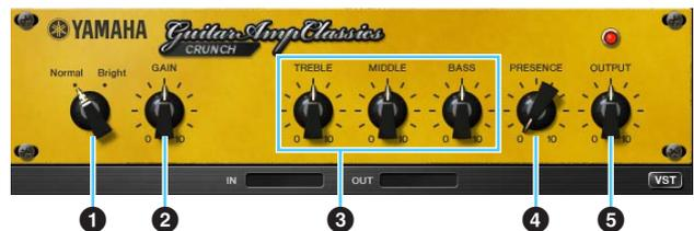
Diesen Verstärkertyp verwenden Sie, wenn Sie leicht übersteuerte verzerrte Klänge benötigen. Das CRUNCH-Modell simuliert die alten Röhrenverstärker, die für Blues, Rock, Soul, R&B und ähnliche Stile bevorzugt werden.
