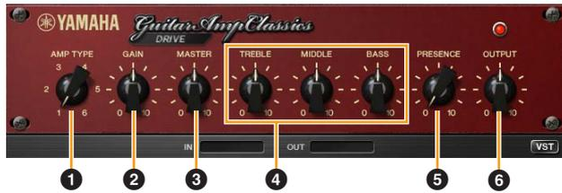
Der Verstärkertyp DRIVE bietet eine Auswahl an Distortion-Klängen, die den Klang verschiedener hoch verstärkender Röhrenverstärker simulieren. Von leicht übersteuertem Overdrive bis zu starken Distortion-Effekten für Hardrock, Heavy Metal oder Hardcore-Stile bietet dieses Modell eine große Klangvielfalt.
