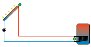
Interner Wärmetauscher, Pumpenlogik
