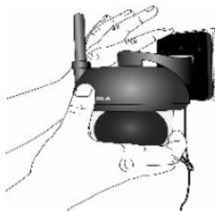
5. Befestigen Sie das Haustiergerät mit den Sicherheitsschrauben im mittleren Loch der Montageplatte. Verwenden Sie dazu den mitgelieferten Schraubenschlüssel.
