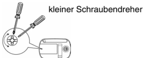
2. Bringen Sie die Abdeckung am Batteriefach wieder an und ziehen Sie die Schraube vorsichtig mit einem kleinen Schraubendreher im Uhrzeigersinn fest.
