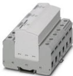
Steckbarer Blitzstromableiter, gem. Typ 1 / Class I, für 2-phasige Stromversorgungsnetze, mit separatem N und PE (L1, L2, PE, N).
