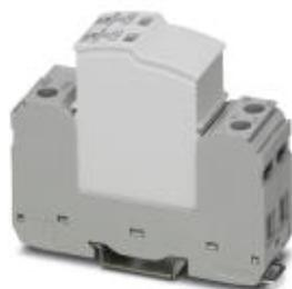
Steckbarer Überspannungsableiter, gem. Typ 2 / Class II, für 2-phasige Stromversorgungsnetze mit kombiniert verlegtem PE und N in einem Leiter (3-Leitersystem: L1, L2, PEN), mit Fernmeldekontakt.
