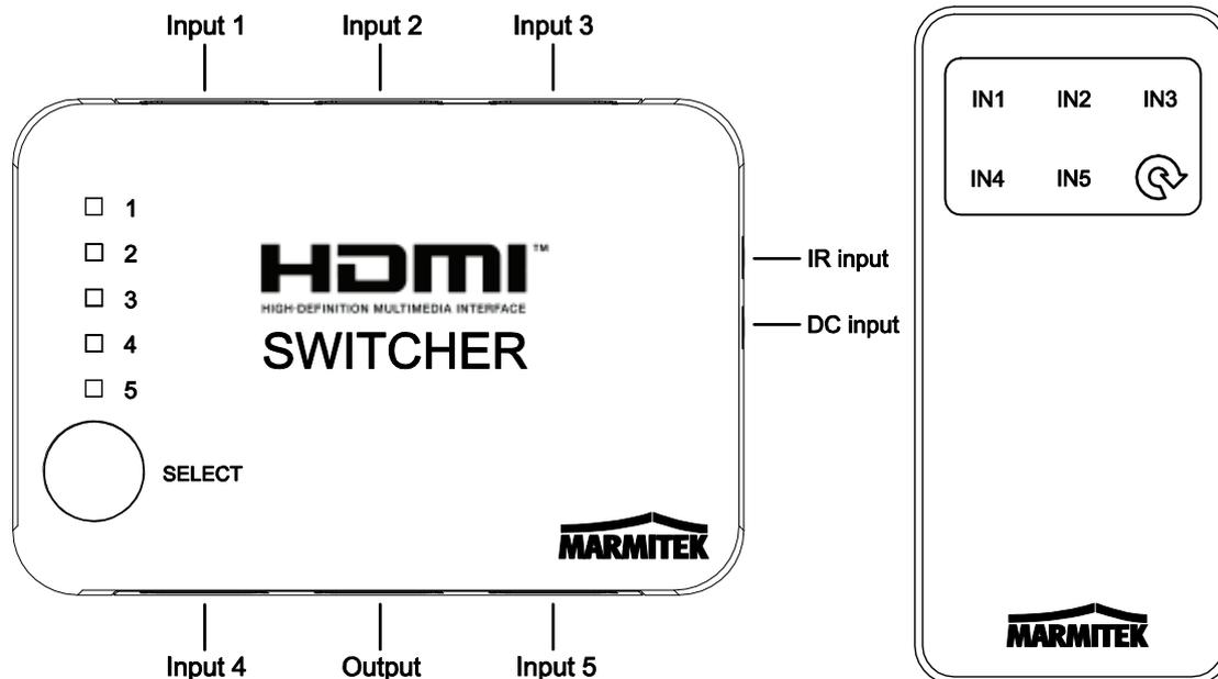
1. Schließen Sie HDMI Quellen (wie Spielcomputer, Blu-Ray Player und digitaler TV Decoder) mit einem HDMI Kabel an die "HDMI Input" Anschlüsse an.
