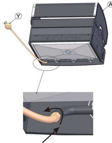
Schrauben Sie Regler und Schlauch (Y) (linksdrehend) an das Gasrohr unter dem Brennergehäuse (A).
