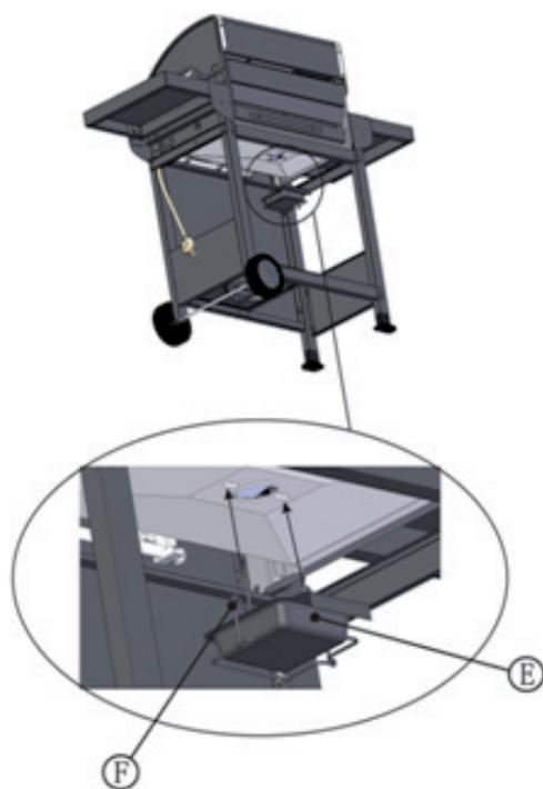
Haken Sie den Halter (F) in die Löcher des Tablett unter dem Brennergehäuse und platzieren Sie die Fettsamlerschale (E) in dem Halter.
