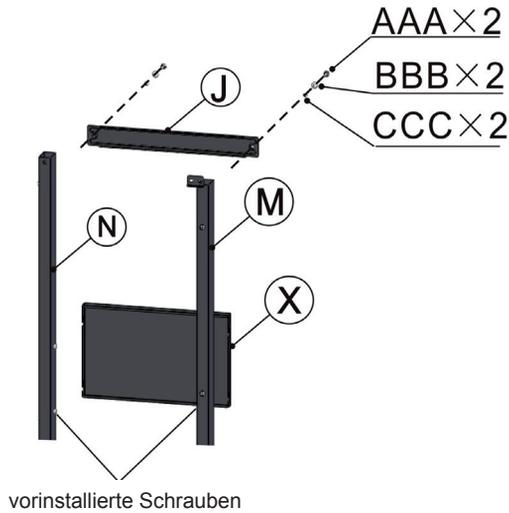
Lösen Sie die vorinstallierten Schrauben an den Standbeinen vorne rechts (M) und hinten rechts (N).
