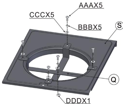
Befestigen Sie die Gasflaschenhalter (Q) mit Schrauben (AAA), Federringen (BBB) und Unterlegscheiben (CCC) an der Bodenplatte (S).
