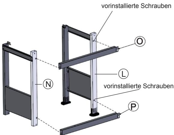
Lösen Sie die vorinstallierten Schrauben an den Standbeinen hinten rechts (N) und hinten links (L)
