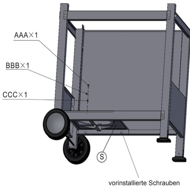
Lösen Sie die vorinstallierten Schrauben unten an der Frontabdeckung (R). Richten Sie die Bodenplatte (S) und die herausstehenden Schrauben aus.
