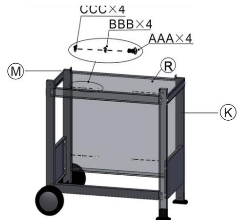
Befestigen Sie die Frontabdeckung (R) mit Schrauben (AAA), Federringen (BBB) und Unterlegscheiben (CCC) an den vorderen Standbeinen (K, M).
