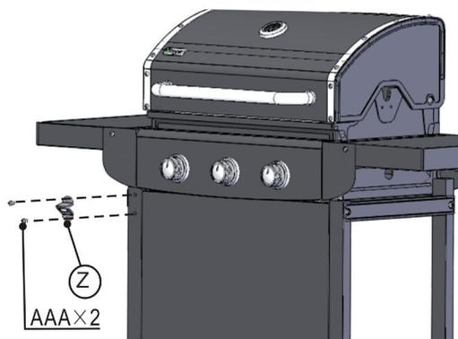
Richten Sie den Flaschenöffner (Z) und die Löcher oben am Standbein (vorne links) aus und befestigen Sie ihn mit Schrauben (AAA).
