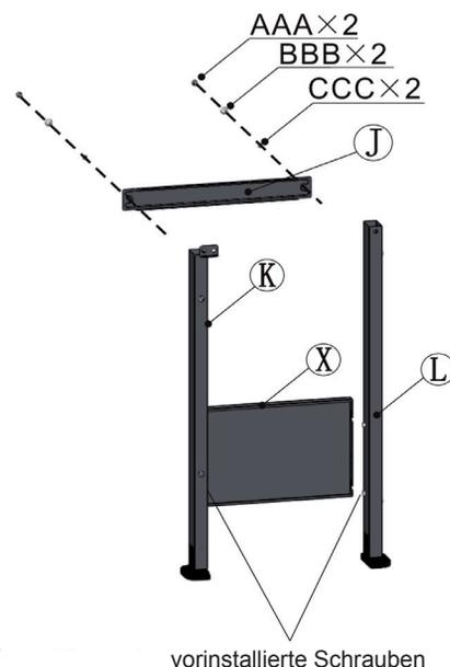
Lösen Sie die vorinstallierten Schrauben an den Standbeinen vorne links (K) und hinten links (L).
