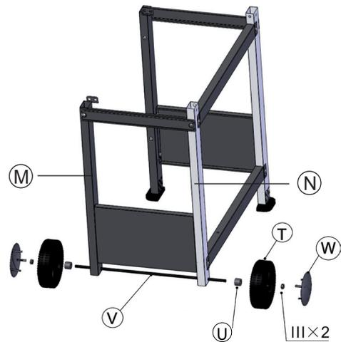
Stecken Sie die Achse (V) unten durch die Löcher in den rechten Standbeinen (M, N).
