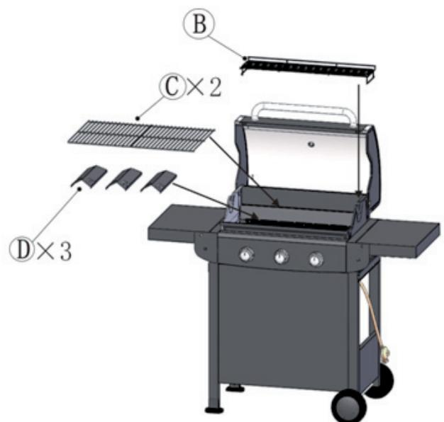
Platzieren Sie die Flammverteiler (D) und die Grillroste (C) im Brennergehäuse.
