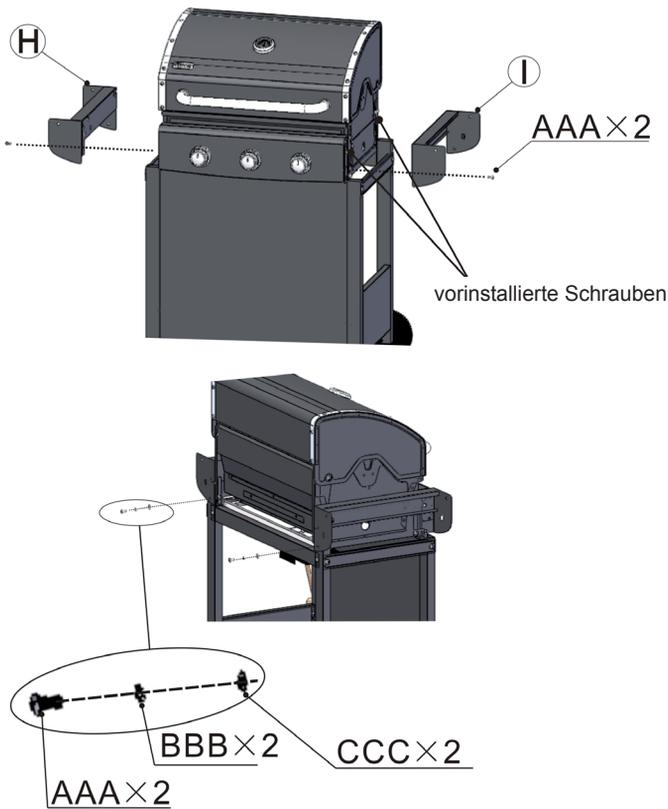
Lösen Sie die vorinstallierten Schrauben an den Seiten des Brennergehäuses (A).
