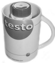
2. Wasser in einem Gefäß (z. B. einer Tasse) auf ca. 50 °C erhitzen. Geschlossene Referenzölfflasche für ca. 10 min in das Wasserbad stellen (Wasserhöhe maximal bis Unterkante Verschlusskappe). Anschließend die geschlossene Referenzölfflasche kurz schütteln, zur besseren Wärmeverteilung in der Flasche.
