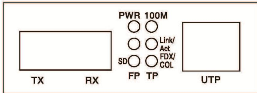
Abb. 2 Konverter Vorderseite für externe Stromversorgung
