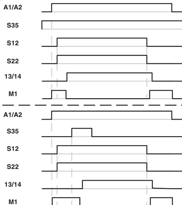
Bild 5 Zeitdiagramm PSR-MS40
