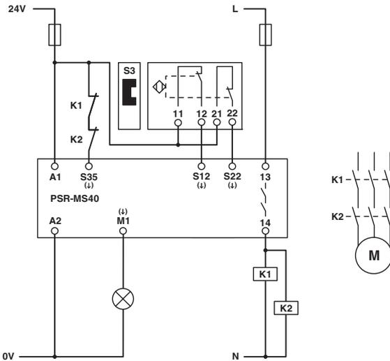
Bild 13 Magnetschalterüberwachung / automatischer Start
