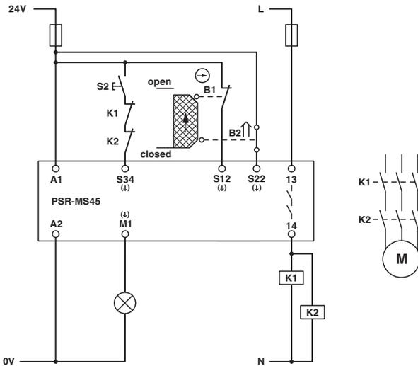
Bild 15 Schutztürüberwachung / manueller, überwachter Start
