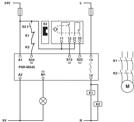
Bild 16 Magnetschalterüberwachung / manueller, überwachter Start
