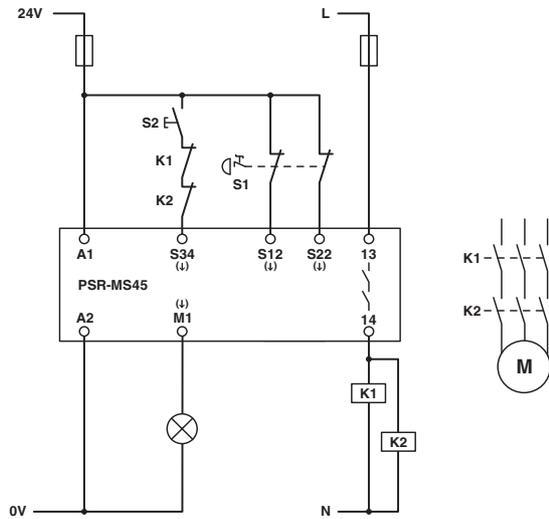
Bild 14 Not-Halt-Überwachung / manueller, überwachter Start
