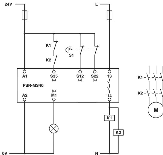
Bild 11 Not-Halt-Überwachung / automatischer Start
