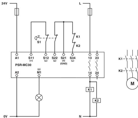
Bild 12 Not-Halt-Überwachung / automatischer Start
