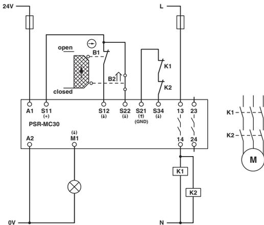
Bild 15 Schutztürüberwachung / automatischer Start / ohne Querschlusserkennung
