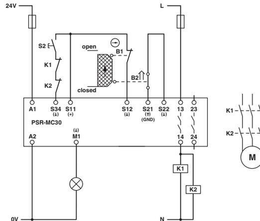
Bild 17 Schutztürüberwachung / manueller, überwachter Start
