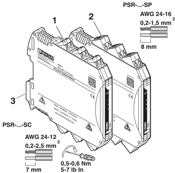
Bild 6 Anschlussvarianten
