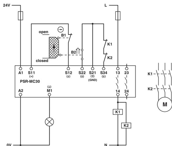
Bild 14 Schutztüroberwachung / automatischer Start
