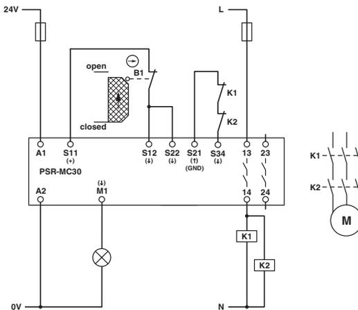
Bild 16 Einkanalige Schutztürüberwachung / automatischer Start
