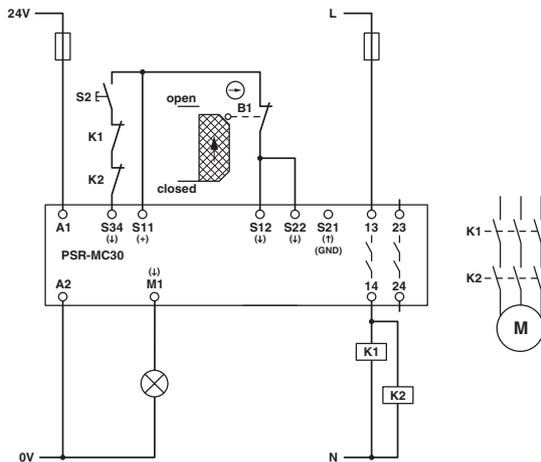
Bild 19 Einkanalige Schutzürüberwachung / manueller, überwachter Start
