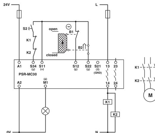
Bild 18 Schutztürüberwachung / manueller, überwachter Start / ohne Querschlusserkennung
