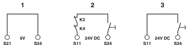
Bild 11 Anschluss automatischer oder manueller, überwachter Start
