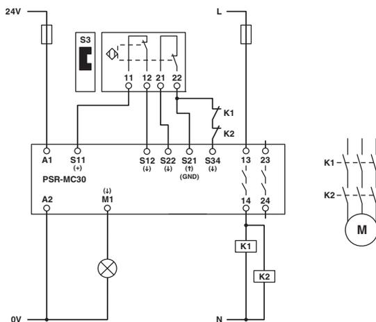
Bild 20 Magnetschalterüberwachung / automatischer Start
