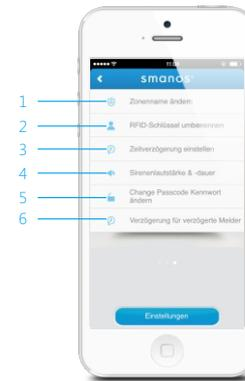
1. Jeder Sensor wird als eine Zone angegeben. Der Name für 50 Sensoren und der Zonenname können je nach Bedarf geändert werden. Ein Name für einen Sensor oder eine Zone darf nicht länger als 30 Zeichen sein.
