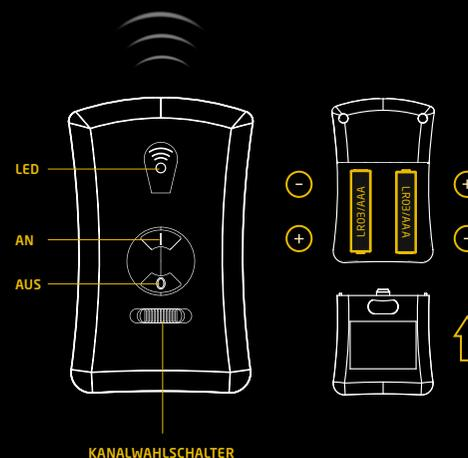
Eine zuvor gemachte Zuordnung zu einem Kanal machen Sie rückgängig indem Sie die betreffenden Leuchtelemente neu initialisieren. Dazu muss der Batteriekontakt einmal unterbrochen werden (Batteriefach öffnen / wieder schließen). Die LED leuchtet dann. Danach können Sie einen anderen Kanal einstellen und die Kerzen, wie oben beschrieben, bedienen.
