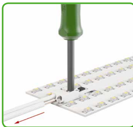
Feindrätige Leiter anschließen und Leiter lösen - durch geringen Druck auf den Betätigungsdrücker, z.B. mit Betätigungswerkzeug 206-860.
