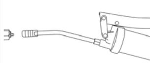
Fettpresse mit dem Hydraulik-Mundstück auf den Schmiernippel aufsetzen.
