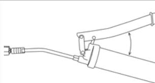
Durch Betätigen des Handhebels (Ausführung Handhebel-Fettpresse, Einhand-Fettpresse) oder des Abzughebels am Handgriff (Ausführung Druckluft-Fettpresse) den Abschmiervorgang ausführen.
