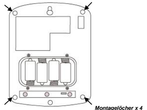
1. Markieren Sie die gewünschte Position an der Wand mit Hilfe der Montagelöcher.
