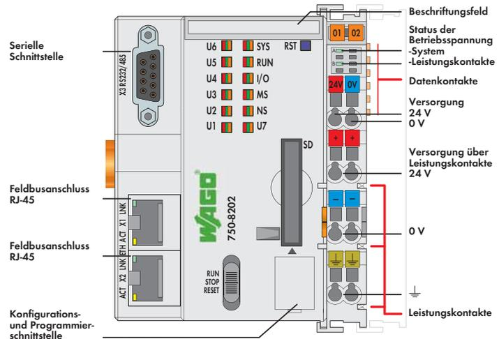
Der Controller PFC200 ist eine kompakte Steuerung an dem modularen WAGO-I/O-SYSTEM. Neben den Netzwerk- und Feldbus-Schnittstellen unterstützt er digitale und analoge Klemmen sowie Sonderklemmen der Serien 750/753.
