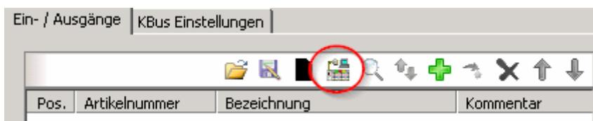
Abbildung 51: Schaltfläche „WAGO-I/O-CHECK starten und scannen“
