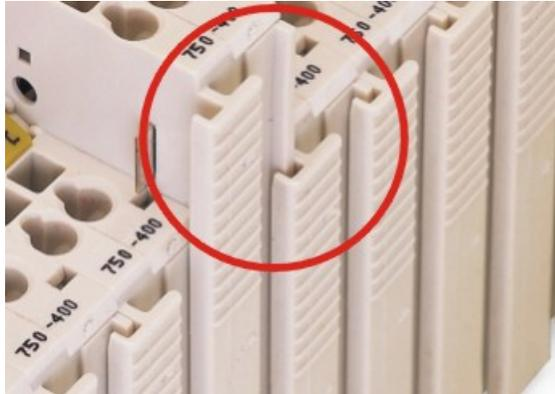
Abbildung 21: Busklemme einsetzen (Beispiel)
