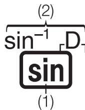
(1) Tastenbelegung (2) Zusätzliche Belegung
