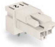
Buchse; für Leiterplatten; abgewinkelte Bauform; 2 Lötstifte pro Pol; 2-polig; Kodierung A
