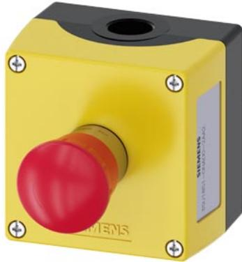
Gehäuse für Befehlsgeräte, 22 mm, rund, Gehäusematerial Metall, Gehäuseoberseite gelb, 1 Befehlsstelle Metall, A=NOT-HALT-Pilzdrucktaster rot, 40 mm, drehentriegelt, Befehlsstelle mittig, 1Ö, Schraubanschluss, Bodenbefestigung, oben und unten je 1xM20
