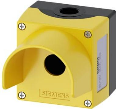
Gehäuse für Befehlsgeräte, 22 mm, rund, Gehäusematerial Metall, Gehäuseoberteil gelb, mit Schutzkragen, 1 Befehlsstelle, ohne Bestückung, Bodenbefestigung, oben und unten je 1xM20
