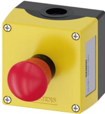
Gehäuse für Befehlsgeräte, 22 mm, rund, Gehäusematerial Kunststoff, Gehäuseoberteil gelb, 1 Befehlsstelle Kunststoff, Befehlsstelle mittig, A=NOT-HALT-Pilzdrucktaster rot, 40 mm, drehentriegelt, 1Ö, Schraubanschluss, Bodenbefestigung, oben und unten je 1xM20
