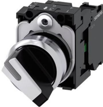
Knebelschalter, beleuchtbar, 22 mm, rund, Metall, hochglanz, weiß, Knebel, kurz, 2 Schaltstellungen O-I, verrastend, Schaltwinkel 90°, 10:30h/13:30h, mit Halter, 1S, Schraubanschluss
