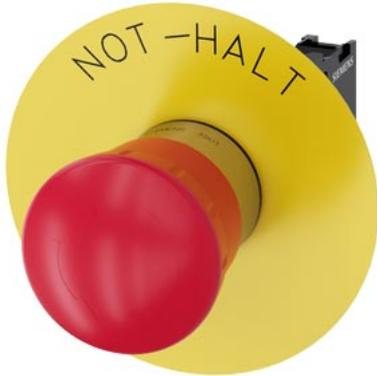
NOT-HALT-Pilzdrucktaster, 22 mm, rund, Metall, hochglanz, rot, 40 mm, zwangsläufige Verrastung, gemäß DIN EN ISO 13850, Drehentriegelung, mit gelbem Unterlegschild, Beschriftung: NOT-HALT, mit Halter, 1Ö, Schraubanschluss
