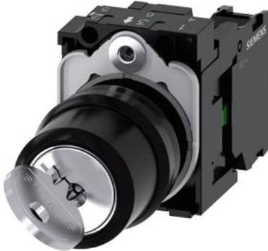
Schlüsselschalter RONIS, 22 mm, rund, Kunststoff, Schließ-Nr. SB30, mit 2 Schlüsseln, 2 Schaltstellungen O-I, verrastend, 10:30h/13:30h, Schlüsselabzug O+I, mit Halter, 1S, Schraubanschluss, mögliche Sonderschließungen: SB31, 421, 455
