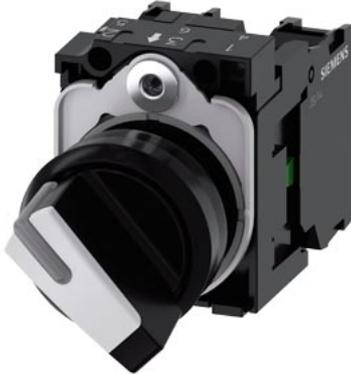
Knebelschalter, beleuchtbar, 22 mm, rund, Kunststoff, weiß, Knebel, kurz, 2 Schaltstellungen O-I, verrastend, 10:30h/13:30h, mit Halter, 1S, 1Ö, Schraubanschluss
