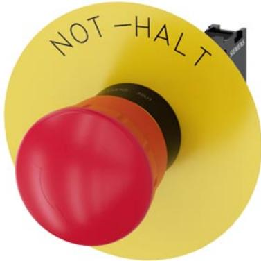
NOT-HALT-Pilzdrucktaster, 22 mm, rund, Kunststoff, rot, 40 mm, zwangsläufige Verrastung, gemäß DIN EN ISO 13850, Drehentriegelung, mit gelbem Unterlegschild, Beschriftung: NOT-HALT, mit Halter, 1Ö, Schraubanschluss
