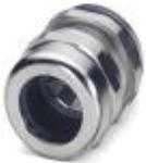
Kabelverschraubung, Material Verschraubung: Messing, vernickelt, Kabelaußendurchmesser 11 mm ... 16 mm, Schirmung: ja, Anschlussgewinde: M25, Farbe: silberfarben
