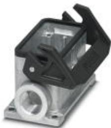
Sockelgehäuse B10, mit Längsbügel, Material: Aluminium-Druckguss, Kabelabgänge: 2, seitlich, Höhe: 54,6 mm, Kabelverschraubung: ohne, Stutzen: nein, 2x M25, Standard
