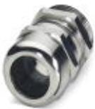
Kabelverschraubung, Material Verschraubung: Messing, vernickelt, Kabelaußendurchmesser 13 mm ... 18 mm, Schirmung: ja, Anschlussgewinde: Pg21, Farbe: silberfarben
