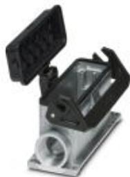
Sockelgehäuse mit Deckel B24, mit Längsbügel, Material: Aluminium-Druckguss, Material Schutzdeckel: PA, Kabelabgänge: 2, seitlich, Höhe: 68 mm, Kabelverschraubung: ohne, Stutzen: ja, 2x Pg21, Standard
