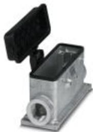
Sockelgehäuse mit Deckel B24, für Querbügel, Material: Aluminium-Druckguss, Material Schutzdeckel: PA, Kabelabgänge: 2, seitlich, Höhe: 68 mm, Kabelverschraubung: ohne, Stutzen: ja, 2x M32, Standard
