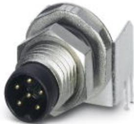
Sensor-/Aktor-Einbausteckverbinder, Stecker, 6-polig, M8, Hinterwand-/Schraubmontage mit M8-Befestigungsgewinde, mit gewinkelten Lötanschluss
