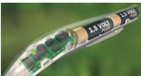
Es sind prinzipiell zwei Behandlungszeiten wählbar, linker Taster für 3 Sekunden und rechter Taster für 6 Sekunden. Nach dem Betätigen eines Tasters wird die Aufheizphase gestartet. Ist die Solltemperatur erreicht, angezeigt durch das Aufleuchten der LED, so bestimmt die autonome Ablaufsteuerung entsprechend des gewählten Zeitbereiches den Bereich der konstanten Temperatur.
