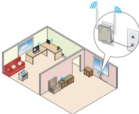
1. Schließen Sie den Repeater an eine Steckdose an und warten Sie bis die Power-LED grün leuchtet.
