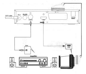
CATV cable RF in CATV-Kabel HF-Eingang
