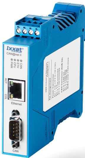
Das CAN@net II/VCI ermöglicht den einfachen und flexiblen Zugriff von einem PC auf CAN-Systeme über Ethernet. Dank der Unterstützung des TCP/IP-Protokolls, kann das CAN@net II/VCI direkt an einen PC angeschlossen, in ein LAN implementiert oder weltweit über das Internet mit dem Gateway kommuniziert werden.
