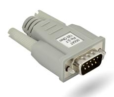
Diese Steckverbinder ermöglichen einen einfachen und schnellen Anschluss an jedes High-Speed CAN/CAN-FD-Produkt. Die Steckverbinder werden verwendet, wenn ein CAN-Knoten ohne internen Abschluss abgeschlossen werden muss oder wenn kein CAN-Knoten am Ende des CAN-Busses angeschlossen ist. Gemäß ISO 11898-2 müssen High-Speed CAN-Busse/Systeme an ihren Enden mit Widerständen abgeschlossen werden.
