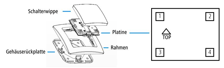
Wenn Sie den Home Control Funkschalter mit Hilfe der doppelseitigen Klebeecken befestigen, kleben Sie die vier Klebeecken auf die vier Ecken der Gehäuserückplatte und fixieren den Home Control Funkschalter an den von Ihnen gewünschten Ort.
