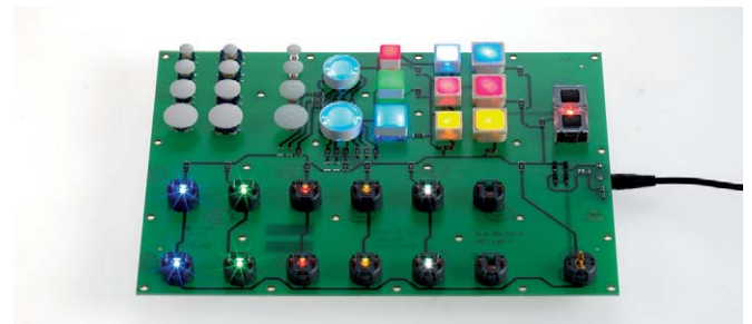
Obere Hälfte: RAFI Kurzhubtaster RACON 8 /12, MICON 5, RF 15/19, Kurzhub-Netzschalter KN 19 Untere Hälfte RAFIX FS Schaltelemente, teilweise mit 3 mm THT-LED
