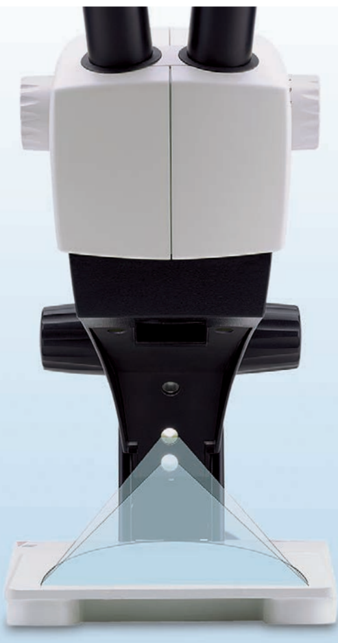
Streiflicht für die Untersuchung von Oberflächen
