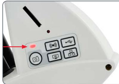
4. Wenn eine andere Modustaste als die Taste für den Ethernet-Modus grün leuchtet, drücken Sie die Ethernet-Modustaste und warten, bis sowohl die Status-LED als auch die Ethernet-Modustaste grün leuchtet.
