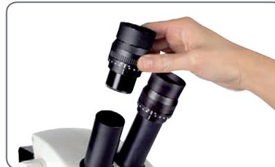
6. Richten Sie die Strichplatten aus, indem Sie das Okular im Tubusrohr drehen.
