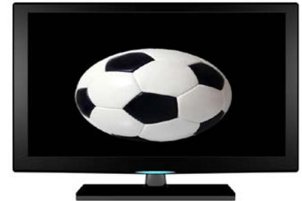
*Bild mit Seitenverhältnis 4:3 an einem Bildschirm mit Seitenverhältnis 16:9*
