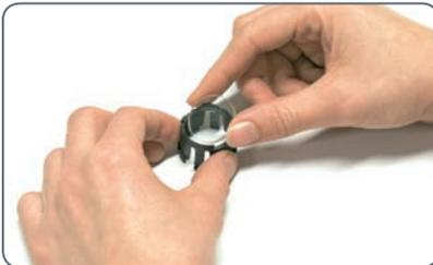
4. Setzen Sie den Einsatz zurück ins Okular. Je nach Okular müssen Sie den Einsatz hineindrücken oder im Uhrzeigersinn festdrehen.
