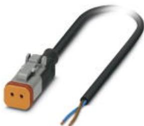
Sensor-/Aktor-Kabel, 2-polig, PUR halogenfrei, schwarzgrau RAL 7021, freies Leitungsende, auf Buchse gerade DEUTSCH DT06-2S Clipverriegelung, Kabellänge: 1,5 m
