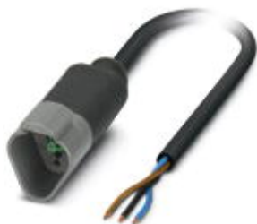
Sensor-/Aktor-Kabel, 3-polig, PUR halogenfrei, schwarzgrau RAL 7021, Stecker gerade DEUTSCH DT04-3P Clipverriegelung, auf freies Leitungsende, Kabellänge: 1,5 m
